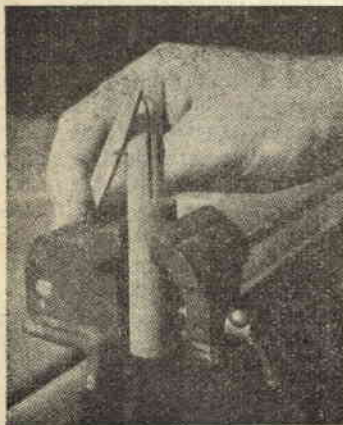
Fig. 2. - Una piccola vite posta perpendicolarmente alla fessura, precedentemente praticata, la renderà regolabile in modo da poter fissare su quella qualsiasi specie di amo.
